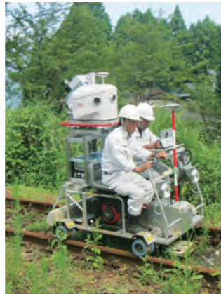
3D計測：車載写真レーザ測量システム (MMS: Mobile Mapping System)
