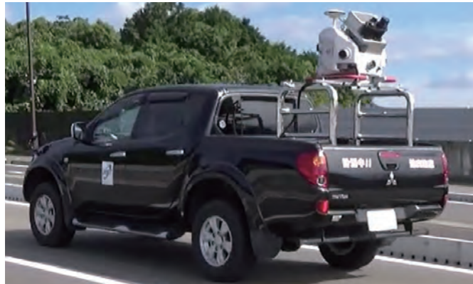
3D計測：車載写真レーザ測量システム (MMS: Mobile Mapping System)
