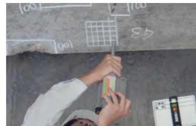
コンクリート強度調査
