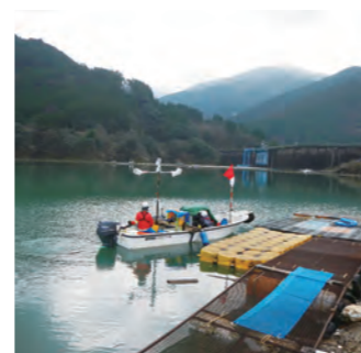
マルチビームによる堆砂測量
